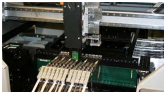
Intérieur de l'ATOZ avec 4 bancs de feeders
